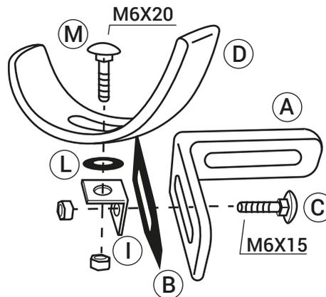
Fixez le support **I** sur le support **A** en utilisant le boulon **C**, interposant entre **A** et **I** la plaque **B**.
