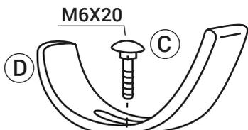
Fixez le support **D** sur le support **A** en utilisant le boulon **C**, interposant entre **A** et **D** la plaque **B**.
