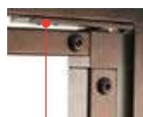
Viti di ancoraggio piastra superiore per smontaggio grata di sicurezza
